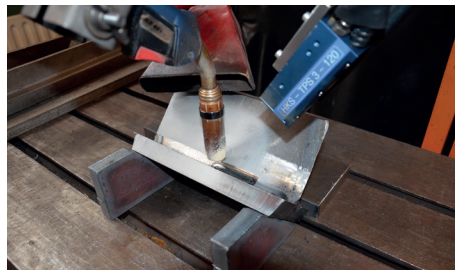
Aufnahme eines Thermogramms bei einem automatisierten Schweißprozess
